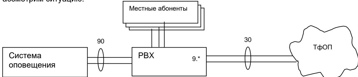
На представленном рисунке транк, соединяющий систему со станцией имеет ёмкость в 90 каналов. В свою очередь, станция подключена к ТфОП транком ёмкостью 30 разговорных каналов. Для вызова абонентов ТфОП используется префикс «9».
