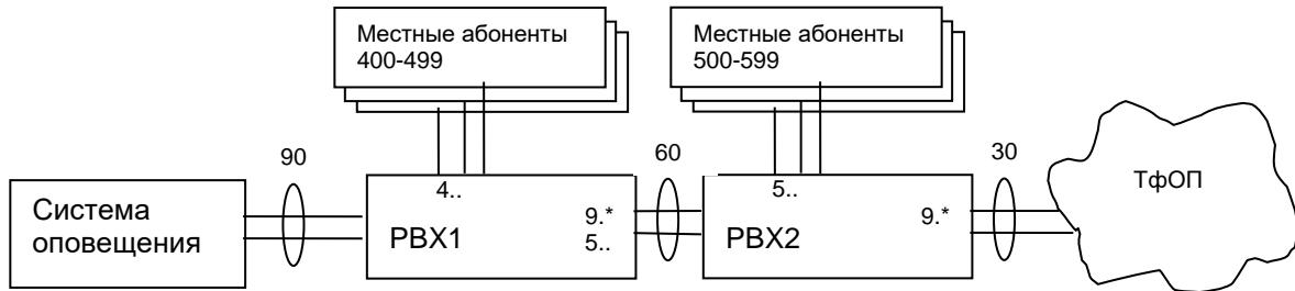
Система оповещения соединена с PBX1 транзом в 90 каналов.
